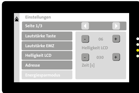
Einstellung des Energiesparmodus
